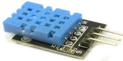
fig.4. DHT11 Sensor
