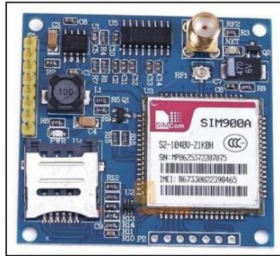
Fig 3.4 GSM module
