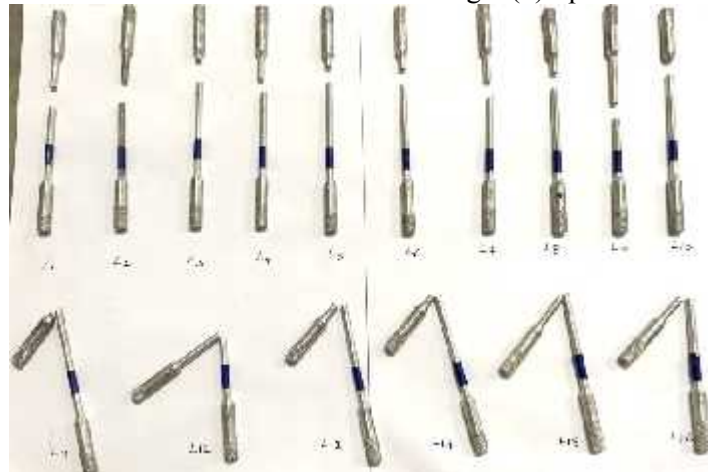
Fig. 3. Tensile specimen ASTM- E8 standard
