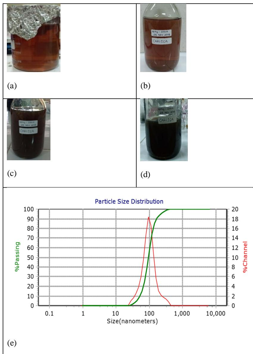
**Figure 1.** Colloidal Silver Nanoparticles (a) 1 Hours, (b) 2 Hours, (c) 24 Hours, (d) 72 Hours, (e) Particle Size Distribution
