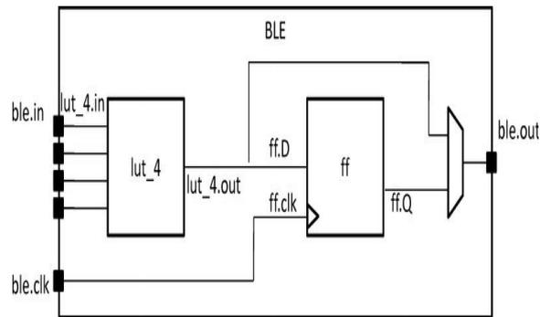
Fig. 6. Four input LUT
