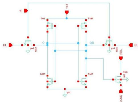
Fig. 2: PP 7T SRAM cell
