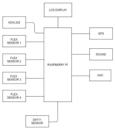
Fig. 1 BLOCK DIAGRAM
